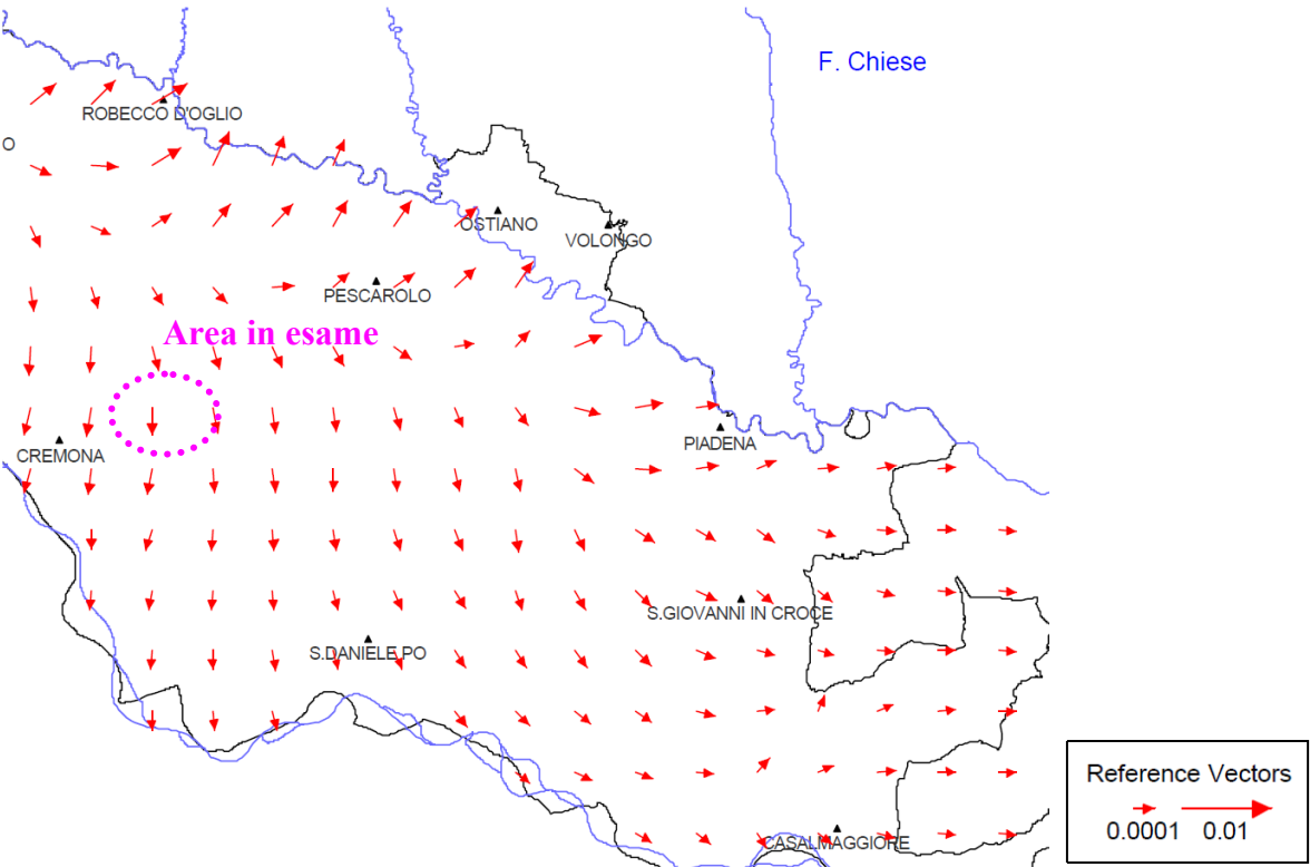
Figura 4 – Gradienti idraulici medi dell’acquifero freatico. “Realizzazione di un modello preliminare del flusso idrico nel sistema acquifero della provincia di Cremona”, Università degli Studi Milano, 2007.
